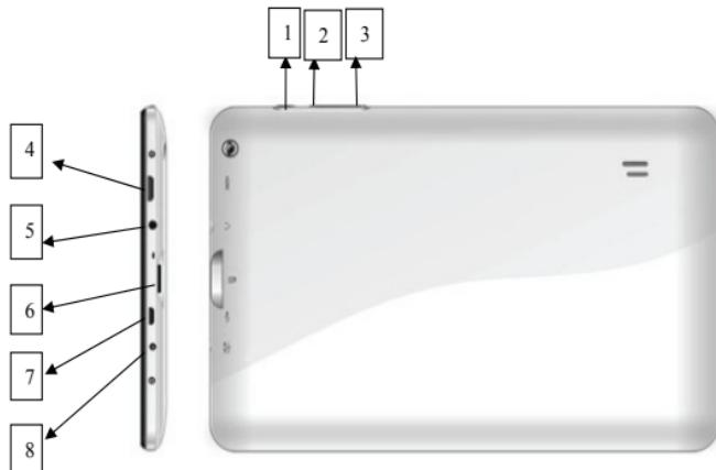
1. “”: botón de encendido: Púlselo brevemente para suspender/reactivar el tablet; manténgalo pulsado para encender/apagar el dispositivo.
